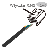
Rysunek 4.18 Usunięcie warstwy izolacji i podłączenie do wtyczki RJ45
